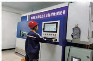
电解质及原铝全自动制样检测设备
